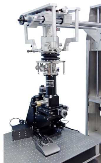
10K 减振制冷机 (橡胶波纹管减震, 集成水平延伸, 匹配水平显微光路, 提供冷头三维移动支架和电控恒温器平移台)
