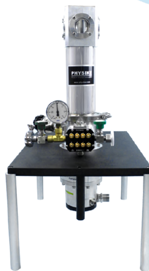
10K 制冷机 (内置钢封氦气腔和 puck 电学样品托)
