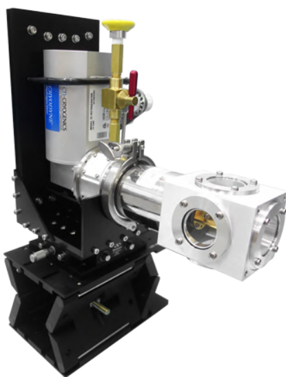
10K 制冷机 (采用 CTI 冷头, 安装在升降支架上)
