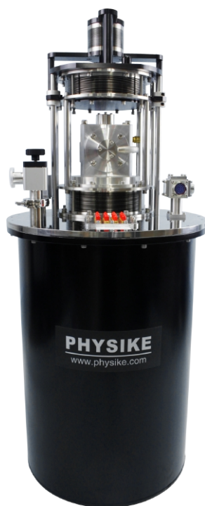
4K 制冷机 ( GM 制冷机, 直径 25cm, 冷头悬浮减震设计, 16 根射频半钢缆 )
