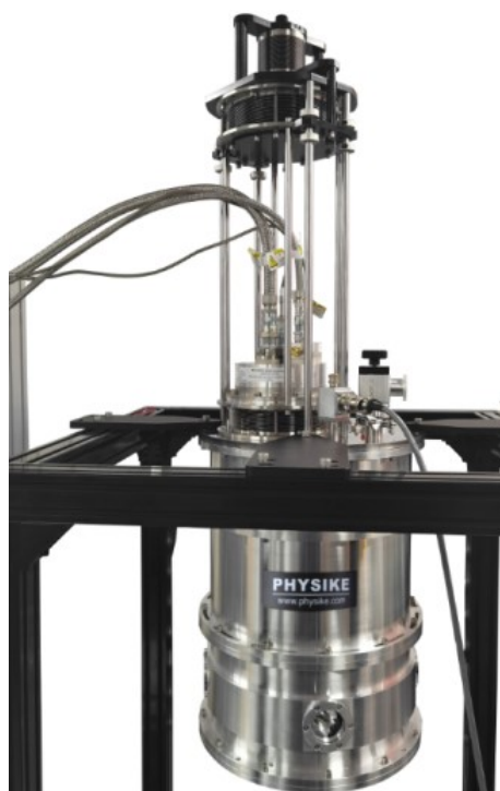
4K 制冷机 ( 阀体分离脉管机, 直径 25cm, 冷头悬浮减震设计, 用于冷却级联激光器和探测器 )
