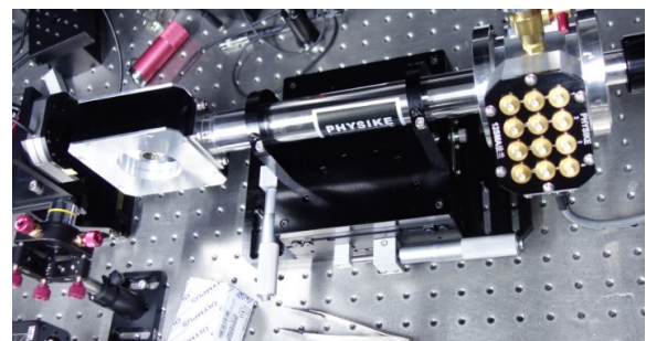
S-300 低温恒温器 (安装 SMA 真空电贯穿、柔性同轴和 puck 样品托, 匹配水平光路)
