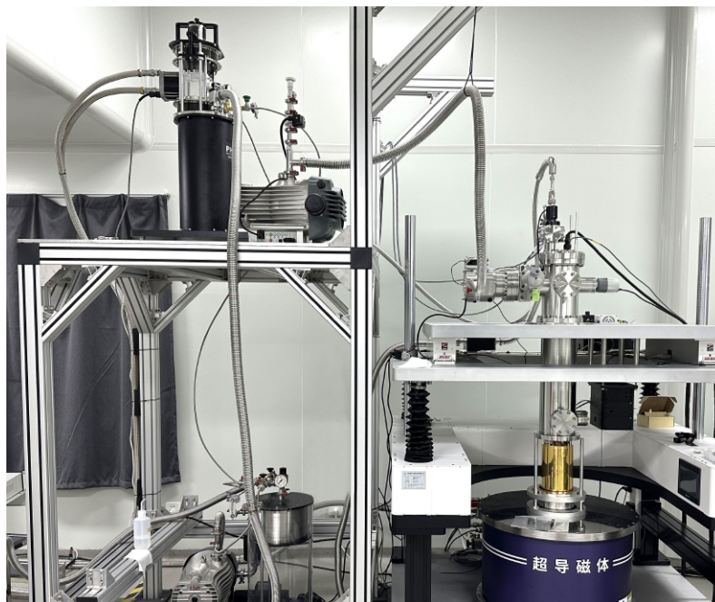
集成 Qcryo-S-400 闭环干式 UHV 低温系统的钻石 AFM 系统，在不消耗液氮的情况下实现最低温度小于 2.5K 的原子级高空间分辨和超高灵敏度探测，是研究材料磁学性质的新利器。
