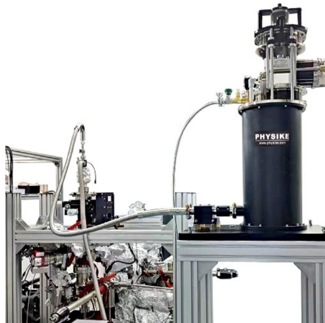
Qcryo-S-400 闭环干式 UHV 低温系统应用于 STM，实现 1 皮米级分辨率。
