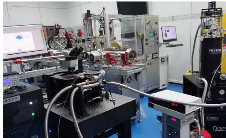
紧凑型无液氦显微低温系统(Qcryo-S-300)集成 BeCu 金刚石对顶压机和双气膜调压机构，允许在低温下远程高精度原位调压，用于低温高压强 X-ray 实验。
