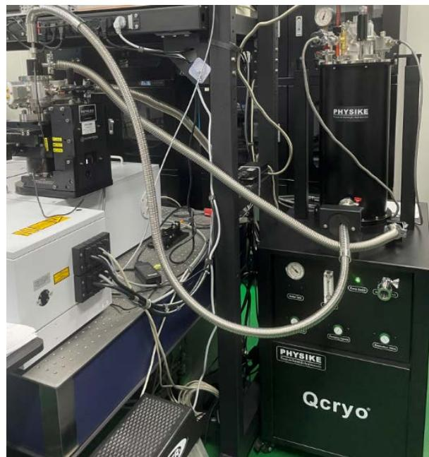
干式超低震动超高真空兼容低温系统(Qcryo-S-200)，冷板尺寸达到 25cm，样品腔高度达 50cm，最低温度：<3K，温度稳定性：±1mK@10min，适合量子器件、离子阱、冷原子/冷分子等测试。
