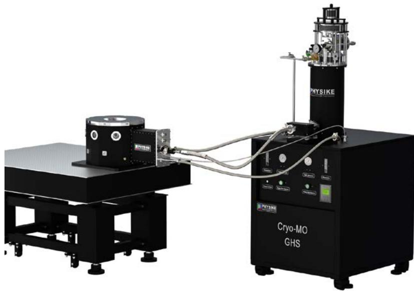
分体式连续型 He-3 制冷机冷源来自氦循环低温系统(Qcryo)，彻底将冷头和压缩机的震动和 He-3 制冷机恒温器隔离，解决目前干式 He-3 制冷机普遍存在的震动较大问题，空载时连续运行的最低温度小于 350mK，应用于 STM 实现皮米级分辨率。
