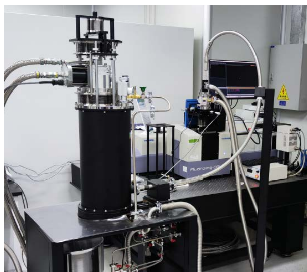
Qcryo-S-100 干式低温系统 匹配黑体辐射源和用户自建 THz 光路
