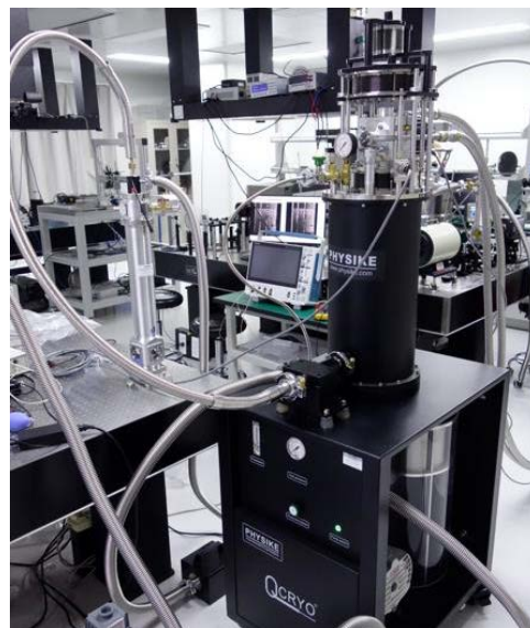
Qcryo-S-100 干式低温系统 匹配黑体辐射源和用户自建 THz 光路
