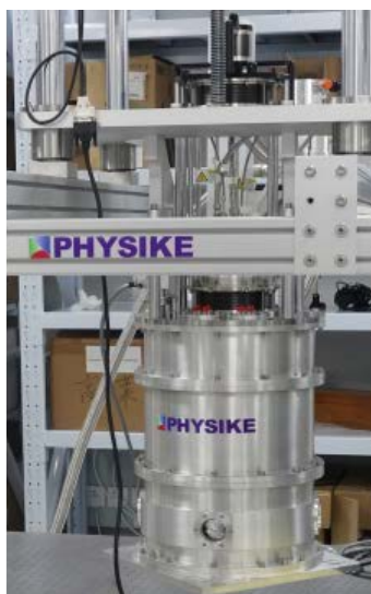
高制冷量阀体分离 4K 脉管机, 冷头悬浮减震设计, 用于冷却 级联激光器和探测器
