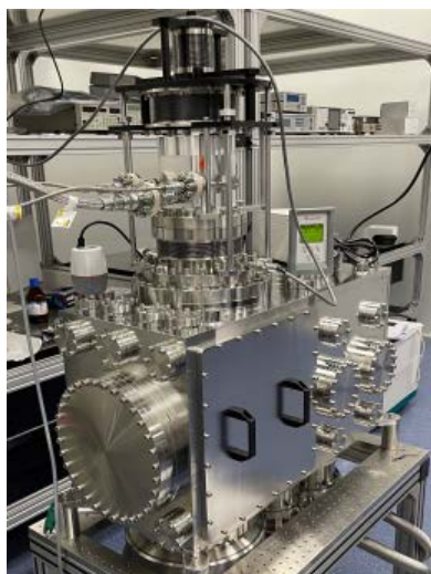
冷头悬浮减震的 4K 脉管机 用于冷原子/冷分子实验
