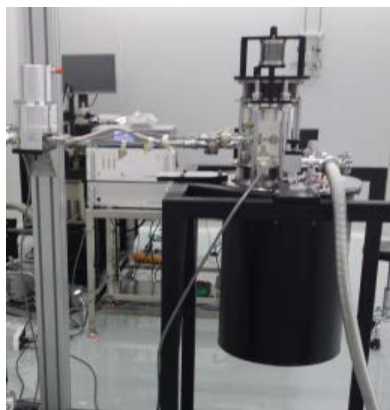
阀体分离 4K 脉管机, 冷头悬浮减震, 集成 16 路射频电贯穿和磁屏蔽罩, 用于 Squid、TES 等量子器件测试
