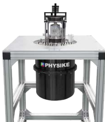
超大尺寸 4K 制冷机, 冷头制冷量: 2.5W@4.2K, 集成直径 30cm 和 40cm 的双 4K 冷板, 安装 52 路 18GHz 射频线路和 8 路 40GHz 射 频线路, 最低温度小于 2.5K
