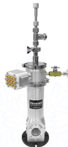
安装 12 个 SMA 真空贯穿和 puck 电学样品托的 V-100 低温恒温器
