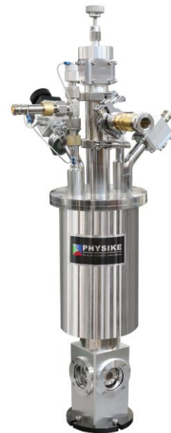
VP-100 气氛液氮型低温恒温器
