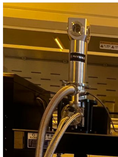
用于 DLTS 测试的 4K 制冷机, 安装四探针样品托, 高温到 500K
