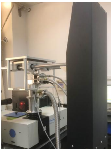
匹配 Horiba Fluorolog-3 荧光光谱仪的 4K 制冷机
