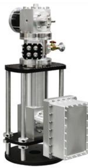
4K 制冷机用于 \gamma 辐照实验, 并提供低温电学测试样品托
