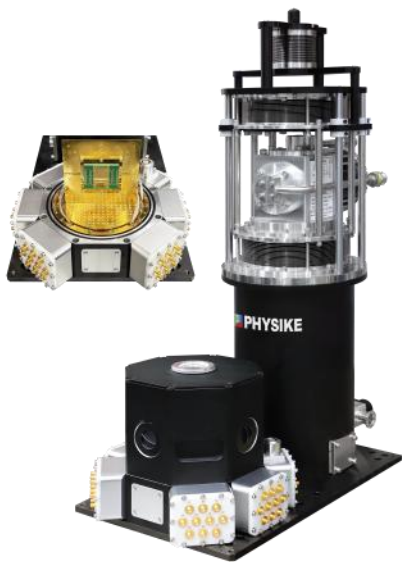
冷头悬浮减震的红外低温系统，冷板直径 尺寸: 20cm, 最低温度: <2.6K, 振动 水平: <50nm, 提供 60 个 SMA 射频贯 穿和 60 根同轴电缆,并集成黑体辐射源, 转用于红外探测器和焦平面(FPA)测试
