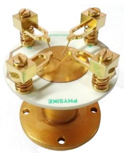
水平四探针样品托 (用于太阳能电池测试)
