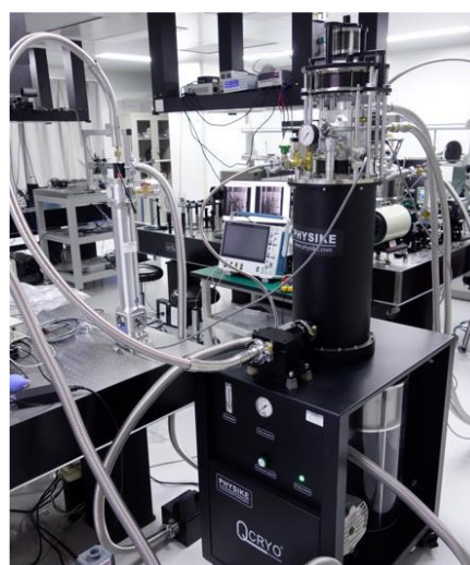
Qcryo-S-100 干式低温系统，匹配黑体辐射源和用户自建 THz 光路
