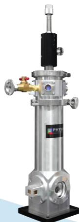
带紧凑型水平延伸的 S-100 低温恒温器，可侧面换样
