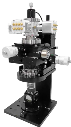
集成三维线性操作器的 S-100 低温 恒温器，匹配 Bruker 80V 光谱仪
