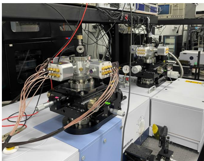
S-100 低温恒温器匹配 Bruker 80V 傅里叶光谱仪
