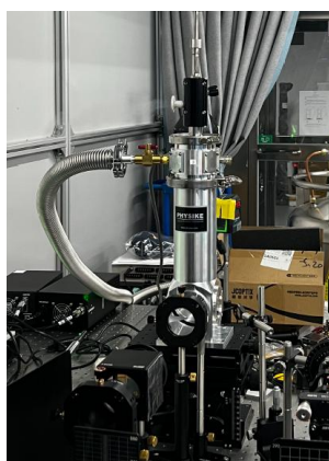
S-100 低温恒温器 匹配红外光路
