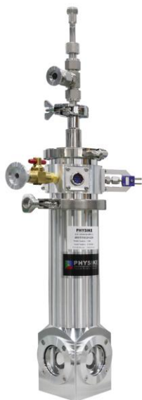
V-100H 高温版低温恒温器的 变温范围: 78K-800K
