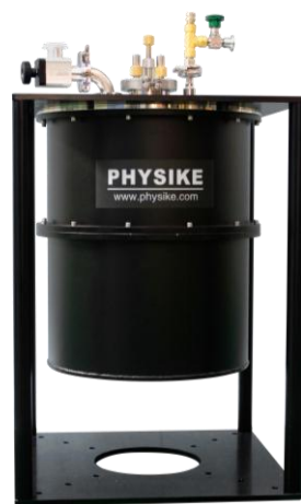
定制型液氮低温恒温器 V-100C, 液氮 储槽容积: 6L, 冷板直径 25cm, 安装 192 根双绞线和 14 根微波半钢缆
