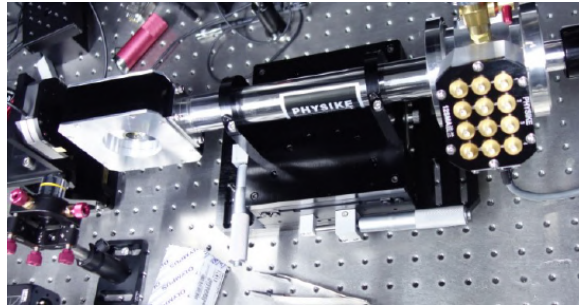
S-300 低温恒温器 (安装 12 个 SMA 真空电贯穿、12 根同轴电缆和 puck 电学样品托, 匹配水平光路)
