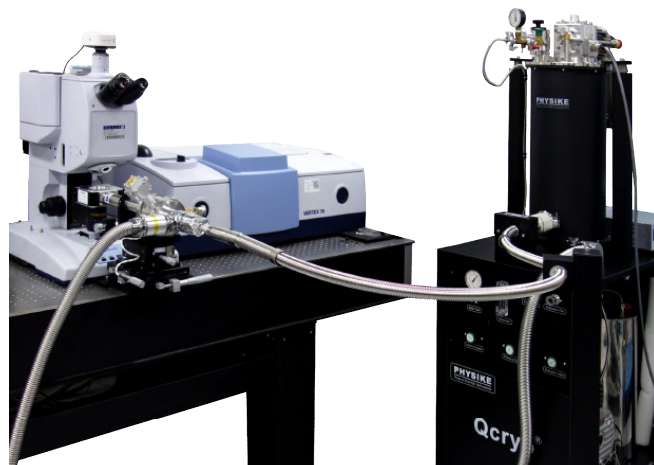
闭环紧凑显微低温恒温器(Qcryo+S-300), 匹配 Bruker 红外显微镜
