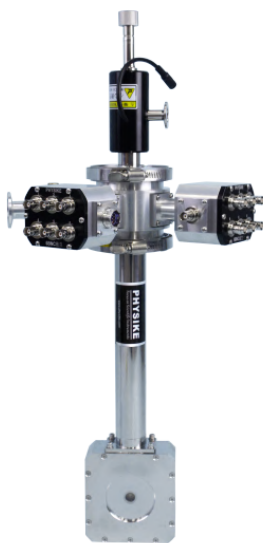
S-300 低温恒温器 ( 不锈钢真空罩、集成 12 个 BNC 真空电贯穿、12 根柔性同轴和 puck 电学样品 )
