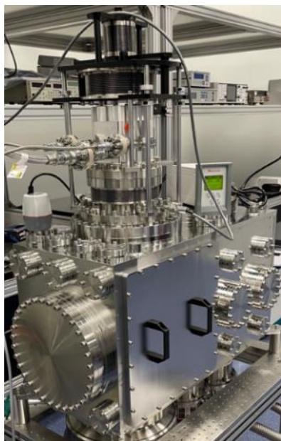
► 冷头悬浮减震的 4K 脉管机 用于冷原子/冷分子实验
