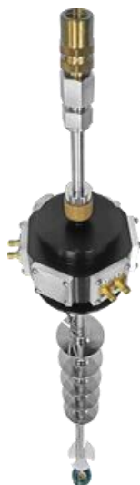
集成微型超导磁体的 Squids 测试样品杆
