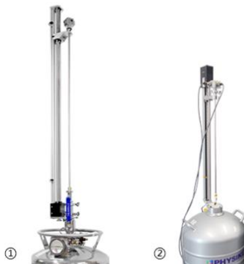
匹配液氮/液氮杜瓦，可快速筛选样品的样品杆
