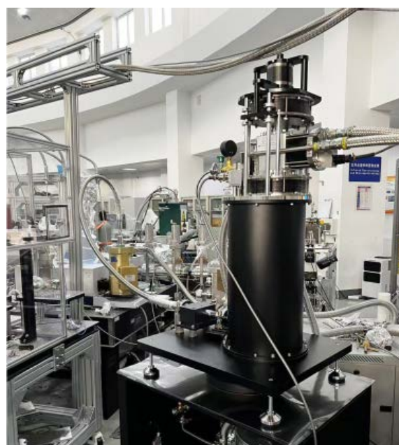
在安徽某高校安装无液氦 Bolometer, 匹配 Bruker 80V 傅里叶光谱仪
