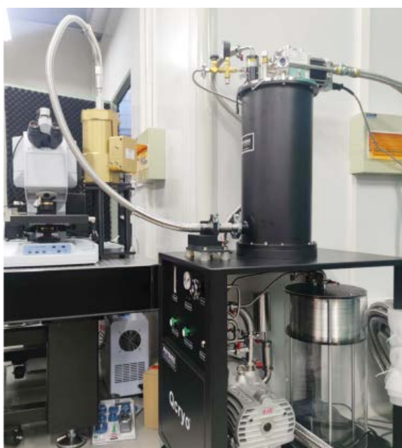
在上海某研究院安装的无液氦 Bolometer, 匹配 Bruker 80V 傅里叶光谱仪和红外显微镜
