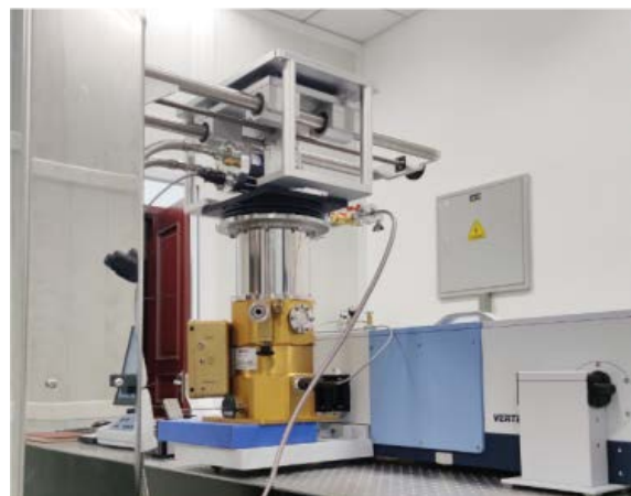
在吉林大学安装基于波纹管减震制冷机的无液氦 Bolometer, 匹配 Bruker 80V 傅里叶光谱仪
