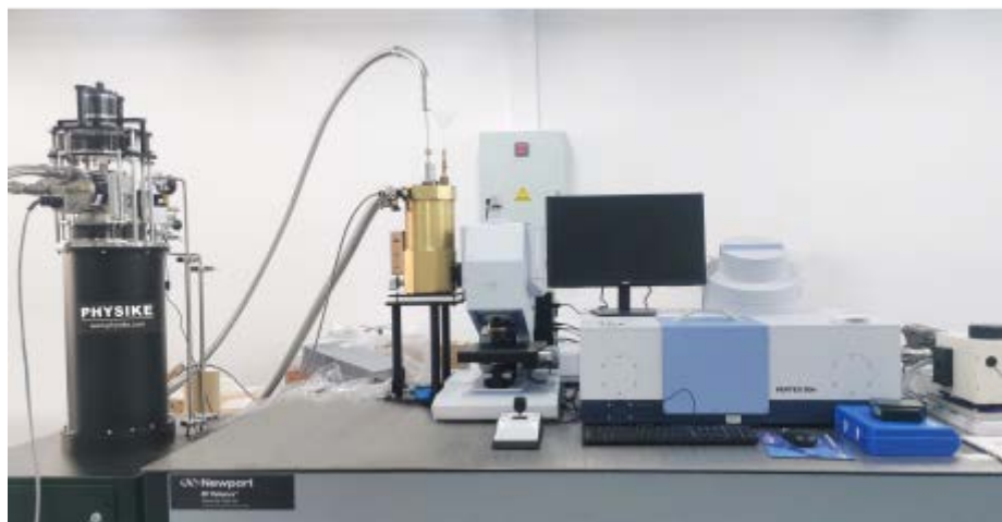
在安徽某高校安装无液氦 Bolometer, 匹配 Bruker 80V 傅里叶光谱仪和红外显微镜
