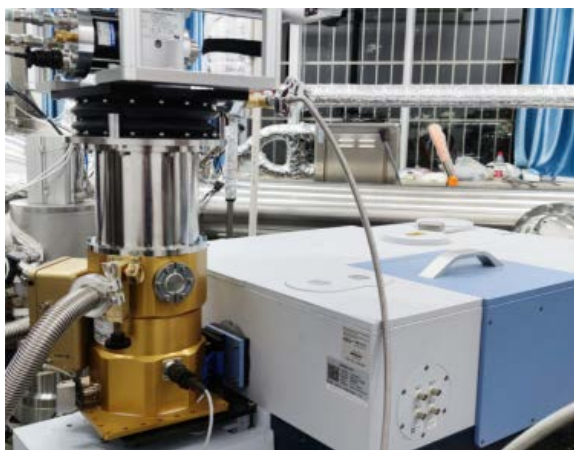
在河南某高校安装基于波纹管减震制冷机的无液氦 Bolometer, 匹配 Bruker 70V 傅里叶光谱仪
