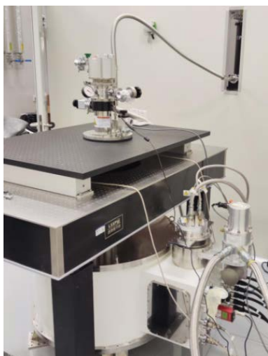
► 大样品腔顶部装卸型干式低温系统(型号: Qcryo-SV-400)
