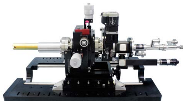
集成五维运动功能的 S-100 低温恒温器 内部图片（匹配电磁铁/超导磁体）
