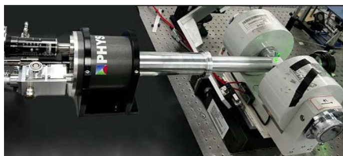
Qcryo-S-100 干式低温系统 带 tilt 转动功能，匹配电磁铁用于磁光测试
