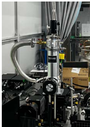
S-100 低温恒温器 匹配红外光路
