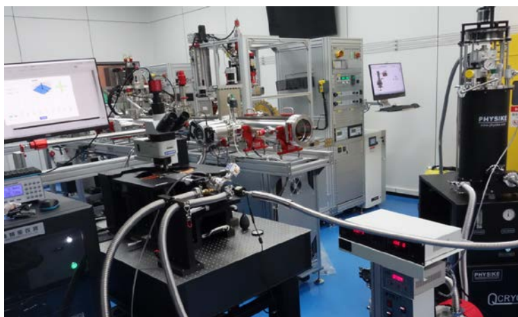
干式闭环显微低温系统(Qcryo-S-300) 匹配磁光克尔显微成像系统，用于低温下磁光克尔显微成像测试和 磁畴反转等测试，最低温度：<2.5K
