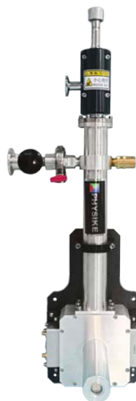
S-300 低温恒温器 带垂直延伸型匹配室温孔超导磁体
