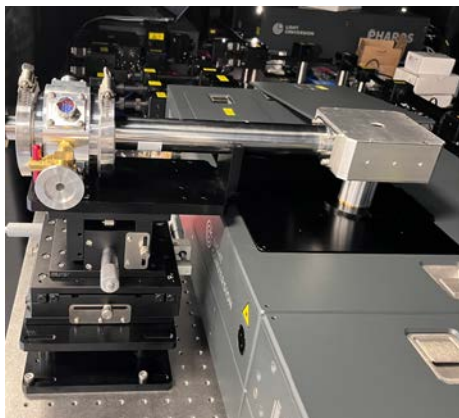
S-300 低温恒温器 匹配 HARPS 超快瞬态吸收光谱仪
