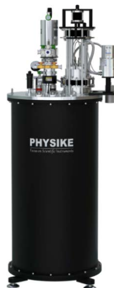
基于阀体分离脉管机、冷头悬浮设计并集成 He-3 插件的低震动干式变温超导磁体系统
